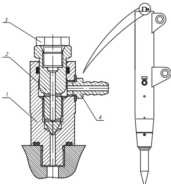
*Рис.б. Вентиль воздушный*
